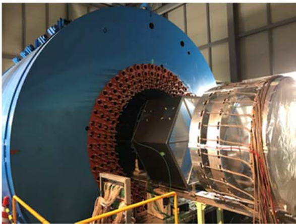
図2：実験が着々と進んでいる SPring-8/LEPS2 スペクトロメーター。大型ソレノイド電磁石とインストール前の飛跡検出器。
