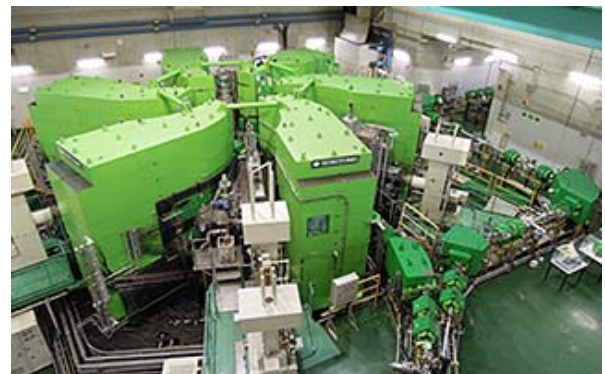
核物理研究センターの加速器 （リングサイクロトロン）
