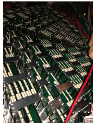
図 4：製作した TPC 読み出し回路
