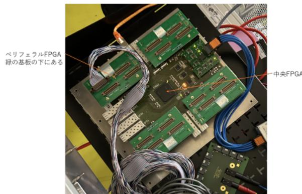
図 3.11 4 つのペリフェラル FPGA および中央 FPGA の写真 [18]。ペリフェラル FPGA は緑の基板に取り付けられており、中央 FPGA はその中央にある。
