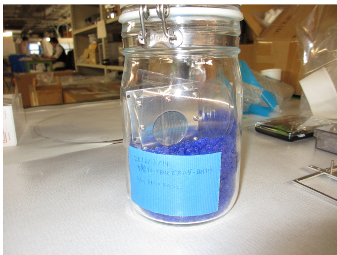
図 5.3 Li 標的。Li は空気中に水分があると N_2 と反応して Li_3N に変化するので、シリカゲルとともに瓶中で保存した。
