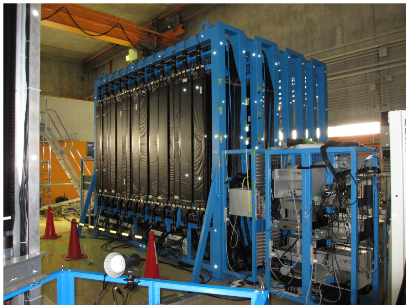
図 3.1 NEBULA。4 架台で構成され、現在は 1, 2 架台目のみ使用されている。手前に見えているのが VETO 検出器で、架台下部に 500ns cable Delay & Attenuator BOX、架台右側にはエレクトロニクス部が見える。
