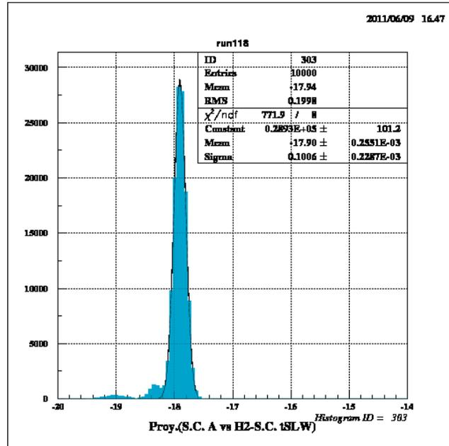
図 2.1 H2 と S.C. 間の飛行時間 (slew 補正済み)[ns]。S.C. と H2 の時間分解能の二乗平均は 100ps と求まった。三つ山が見えるが、これは理解されるべき問題で、時間分解能の評価に対して影響はないと考えている。
