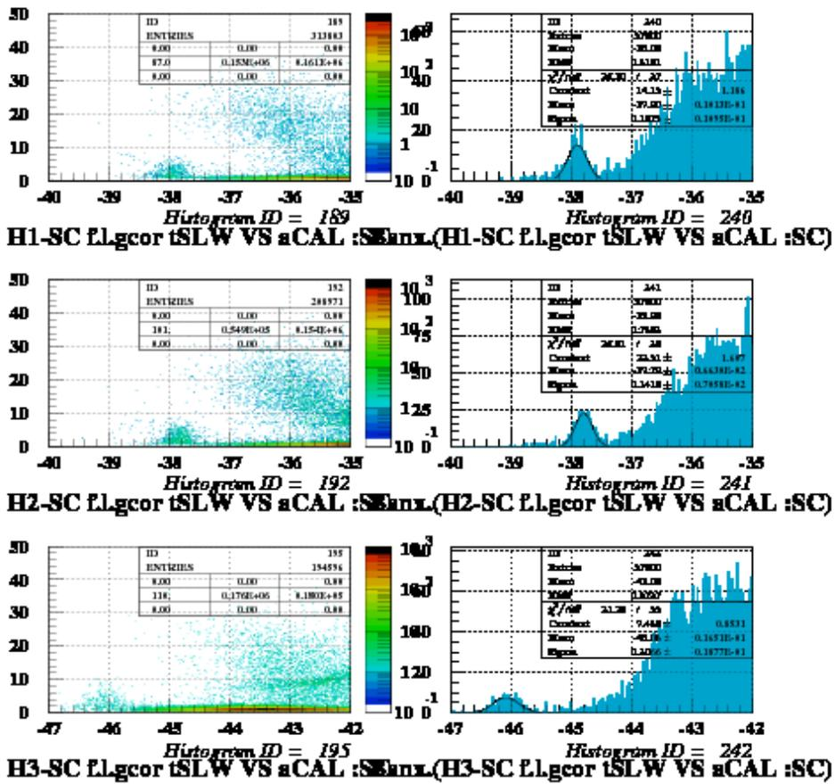
図 2.2 H1,2,3 と S.C. 間の飛行時間 (slew 補正済み)[ns] vs H1,2,3 のエネルギー [MeV] (gate:S.C.,P283 解析ノート vol.1 p42 参照)。y 軸について 3MeV から 50MeV までを x 軸にプロジェクションした結果。それぞれの時間分解能の二乗平均は 157ps,141ps,207ps と求まった。
