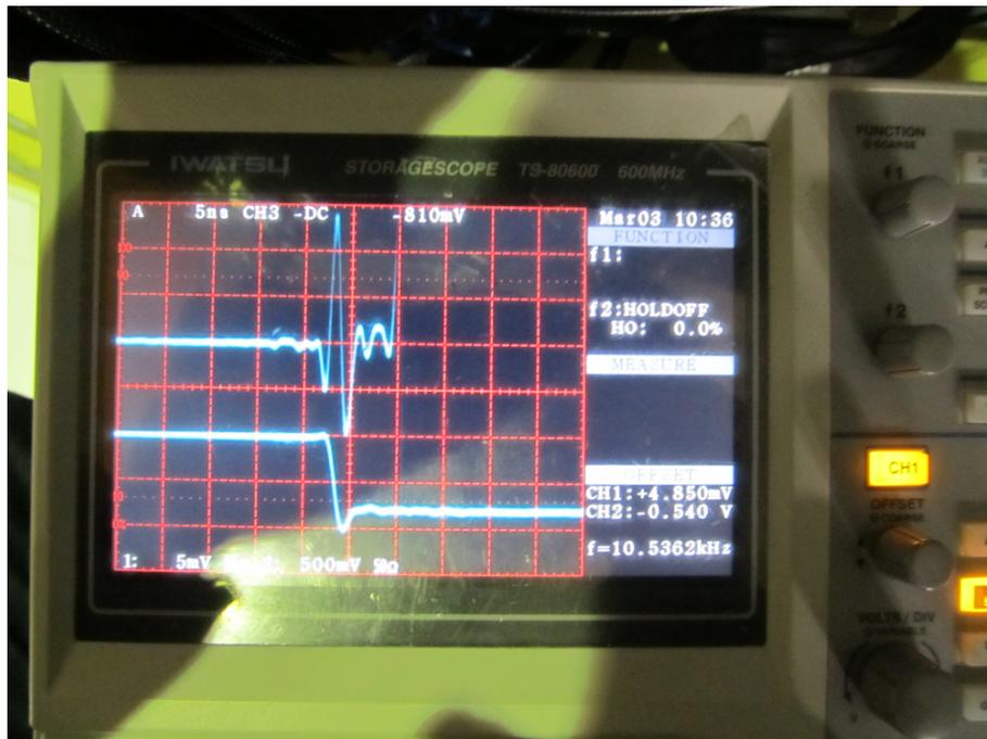
図 3.1 干渉パルスが最も大きい場合。下側のシグナル (chB) が立ち上がる時に上側のシグナル (chA) で  $dV=\pm 10$  mV,  $T=3$  ns 程度の干渉パルスが見える。
