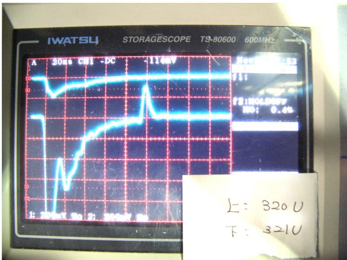
Fig. 1: BNC 8 m後のPMTのシグナル。320Uが不審なPMT
